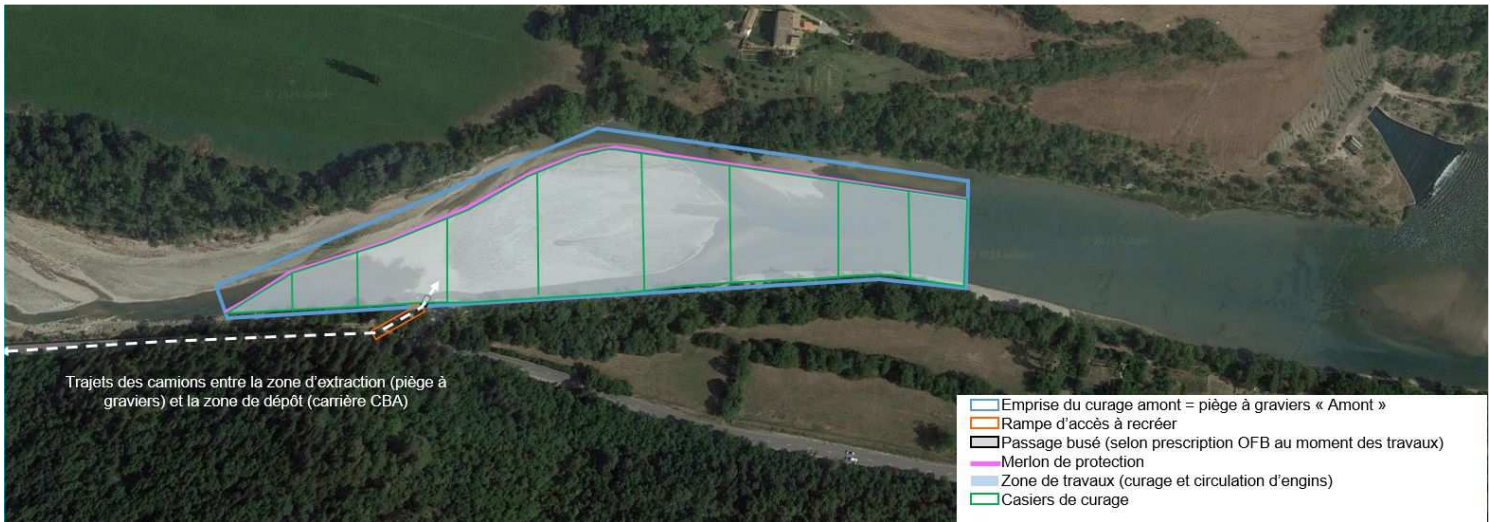
Schéma de principe du curage du piège à graviers « Amont » avec une chenalisation du Buëch en rive gauche
