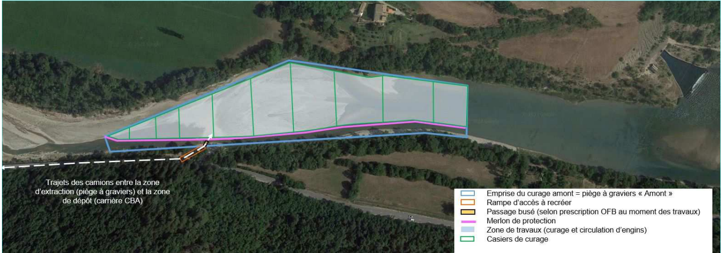
Schéma de principe du curage du piège à graviers « Amont » avec une chenalisation du Buëch en rive droite
